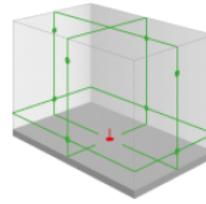
Laser croix et lignes avec 4 lignes horizontales vertes et 4 lignes verticales (= point d'aplomb haut et bas + 4 angles de 90 °). Chaque ligne a 1 point de laser pour une meilleure visibilité, même dans un environnement lumineux ou à l'extérieur. Nivellement motorisé électronique avec précision de 1 mm/10 m. Portée de 50 m avec récepteur (en option). Le réglage fin pivote précisément autour du point d'aplomb. Batterie Li-Ion avec adaptateur secteur/chargeur.
