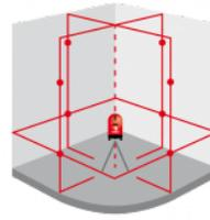
Laser croix et lignes avec 4 lignes horizontales rouges et 4 lignes verticales (= point d'aplomb haut et bas + 4 angles de 90 °). Chaque ligne a 1 point de laser pour une meilleure visibilité, même dans un environnement lumineux ou à l'extérieur. Nivellement motorisé électronique avec précision de 1 mm/10 m. Portée de 50 m avec récepteur (en option). Le réglage fin pivote précisément autour du point d'aplomb. Batterie Li-Ion avec adaptateur secteur/chargeur.
