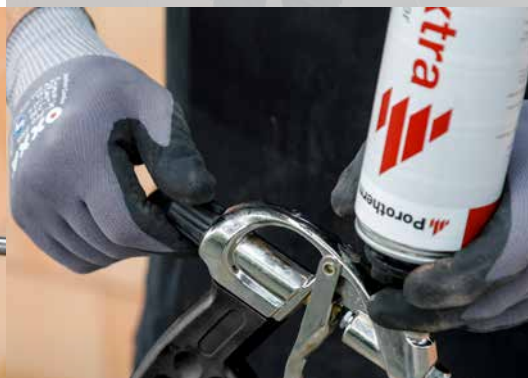
4. Het debiet regelen met de regelschroef
