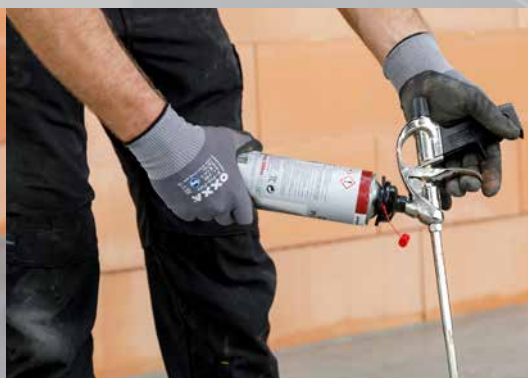
4. Het debiet regelen met de regelschroef
