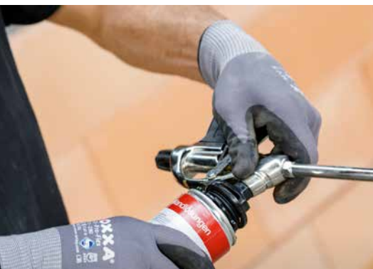
3. De bus Dryfix extra op de gereinigde spuitmond schroeven en lichtjes aandraaien
