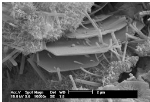
Hydratation d'un liant à base de ciment Portland dans un mortier de jointoiement traditionnel
