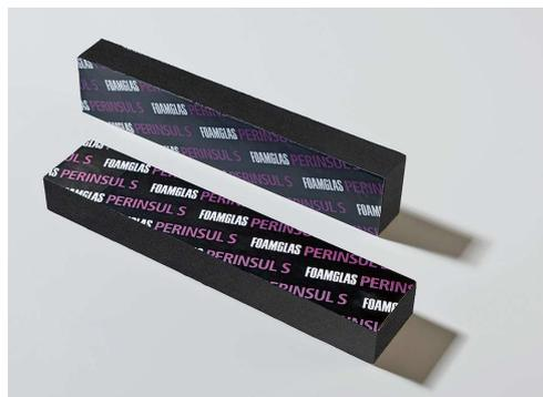
FOAMGLAS® PERINSUL S est un bloc isolant à très haute résistance à la compression pour éviter les ponts thermiques. Deux faces du bloc sont enrobées de bitume et revêtues d'un voile de verre pour assurer une bonne adhérence avec le mortier. La face supérieure est de couleur mauve.
