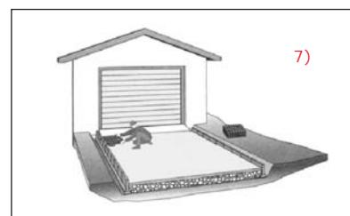
7) On assemble ensuite les dalles gazon en direction longitudinale. On les fixe ensuite en direction transversale. A cet effet, on incline quelque peu les dalles et on glisse la lèvre dans l'évidement avec le rehaussement ponctuel. On dame ensuite légèrement les dalles.
