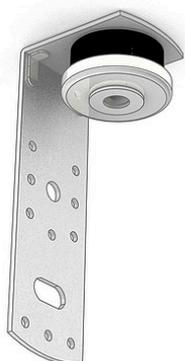
PA40/120 est une suspente acoustique universelle pour les plafonds Metal Stud® à grandes portées destinée à des applications dans le parachèvement à sec. La suspente se compose d'acier DC01 suivant NBN EN 10130:2007, thermozingué (Fe/Zn/8/A suivant NBN EN ISO 2081:2009), avec anneau de raccordement en caoutchouc. La suspente pour plafonds a une épaisseur de 3 mm, des dimensions de 40 x 120 mm et est pourvue d'une ouverture M8.
