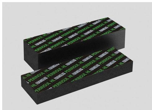
FOAMGLAS® PERINSUL HL est un bloc isolant à très haute résistance à la compression pour éviter les ponts thermiques. Deux faces du bloc sont enrobées de bitume et revêtues d'un voile de verre pour assurer une bonne adhérence avec le mortier. La face supérieure est de couleur verte.
