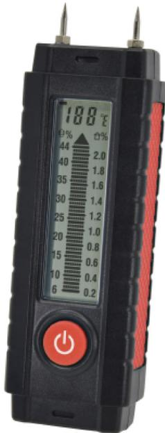
Plage de mesure bois: 6 - 44%, Précision bois: +/- 2%, Plage material de construction: 0.2 - 2.0 %, Précision material de construction: 0.1%
