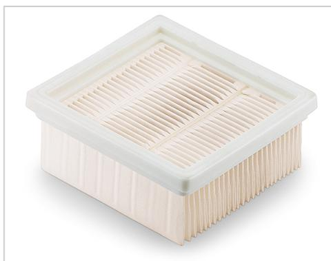
Filtre en papier à plis plats de classe H/HEPA 13. En matériau spécial avec un taux de perméabilité < 0,005 %. Surface antisalissure et longue
