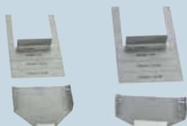
Des abouts spéciaux en acier inoxydable sont utilisés en combinaison avec la pièce intermédiaire BFL pour fermer la ligne de caniveau de manière étanche. Ils sont plus étroits que les abouts Euroline ordinaires afin de fermer discrètement le caniveau à hauteur des ébrasements.
